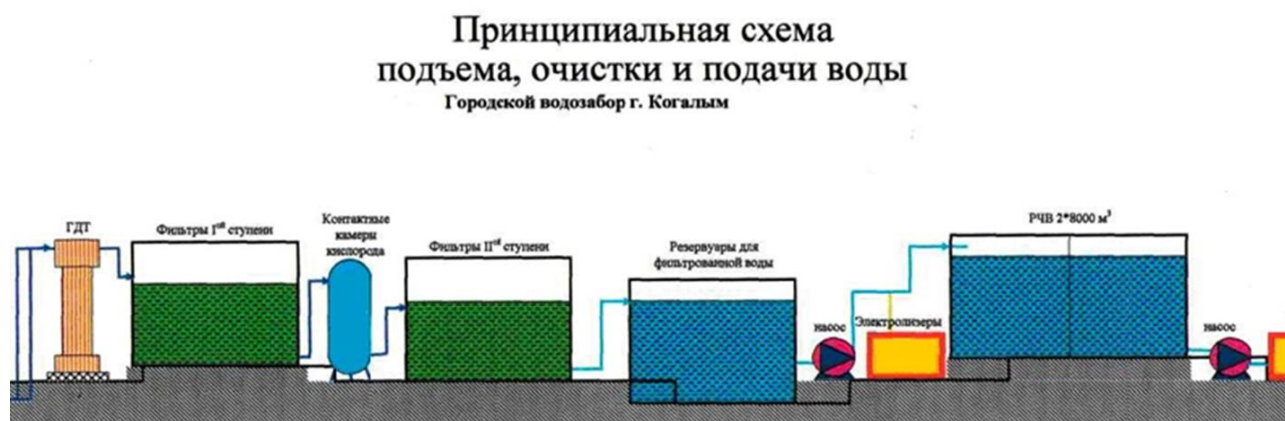
Рисунок 3. Принципиальная схема подъема, очистки и подачи воды
